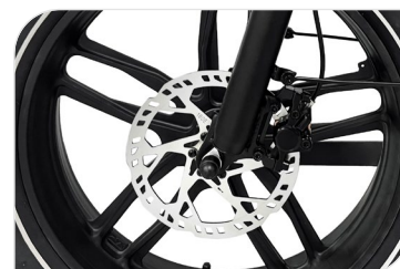
Freni a disco idraulici con cut off
