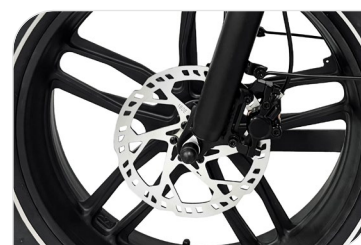
Freins à disque hydrauliques avec coupure moteur
