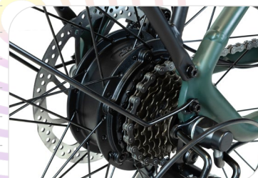
Motore Sutto Bafang, 250 W, 36 V, 35 Nm
